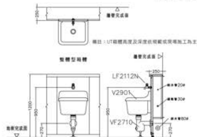
圖號 AV2901-B 上蓋材 人造大理石 面盆 鍍鉻鋼粉粒噴塗裝/皮紋鋼面/熱固性樹脂板/海星 座圈 316SUS304不銹鋼板 沖水 鍍鉻鋼粉粒噴塗裝
