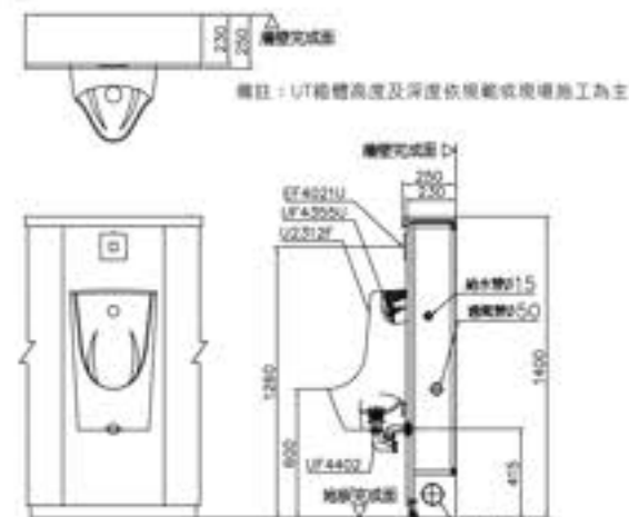
圖號 AU2312F-S 上蓋材 人造大理石 面盆 鍍鉻鋼粉粒噴塗裝/皮紋鋼面/熱固性樹脂板/海星 座圈 316SUS304不銹鋼板 沖水 鍍鉻鋼粉粒噴塗裝
